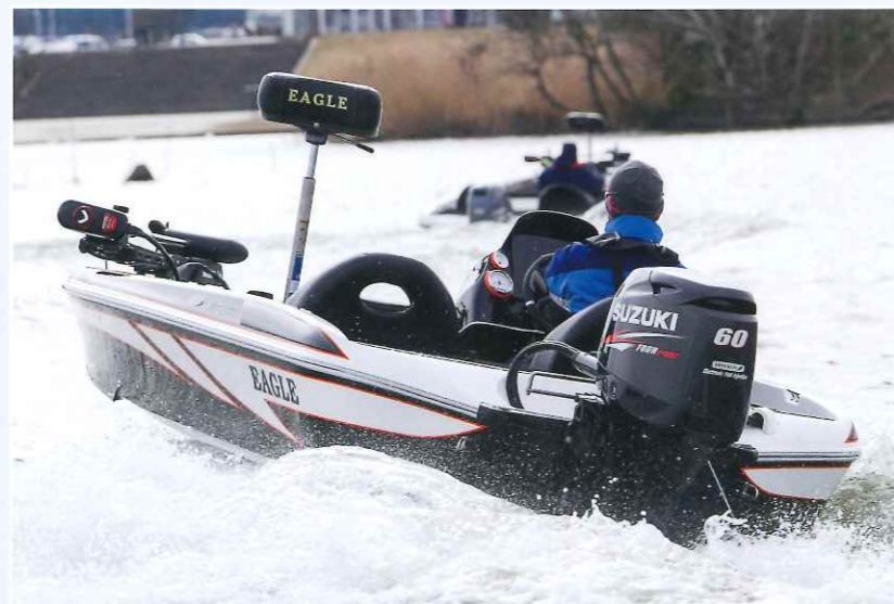
船底に充填されたウレタンフォームにより、波からの衝撃をやわらげ、体への負担を低減しています。
