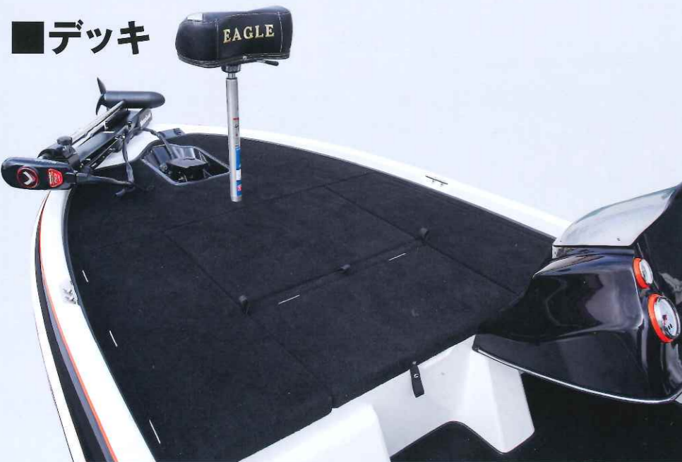
デッキをキャストしやすいよう大型化。疲労軽減のためオフセットボックスを標準装備。
